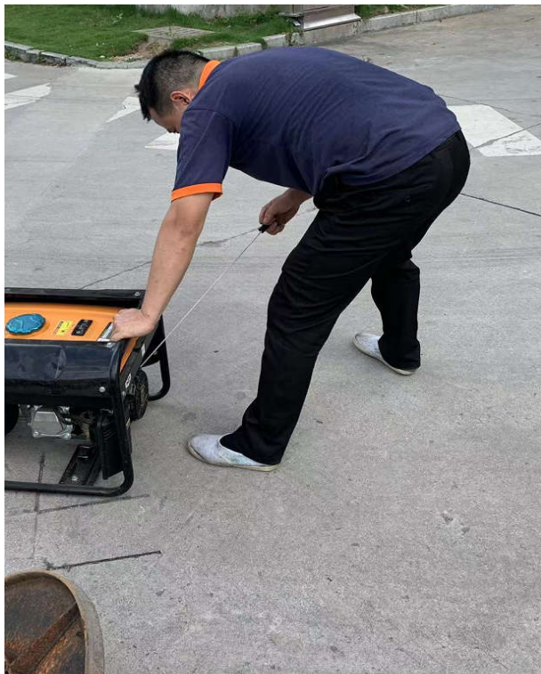
启动发电机发电抽水
